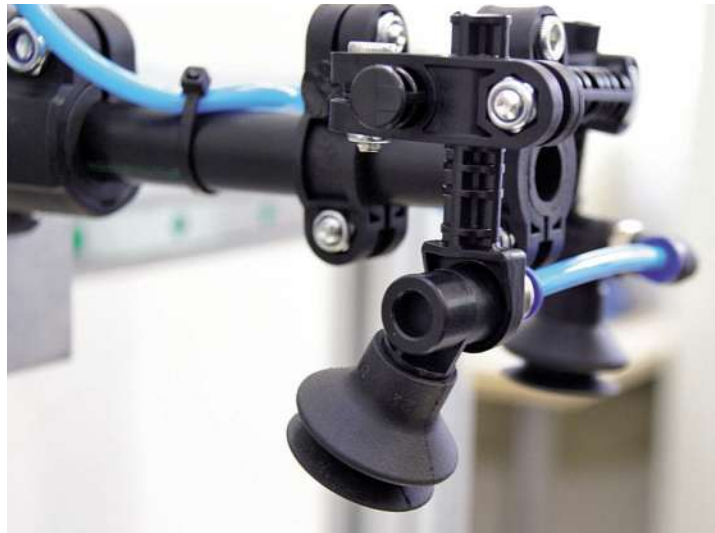
Bild 2: Die Herga-Leichtbausauger bestehen aus Kunststoff und lassen sich leicht montieren.
